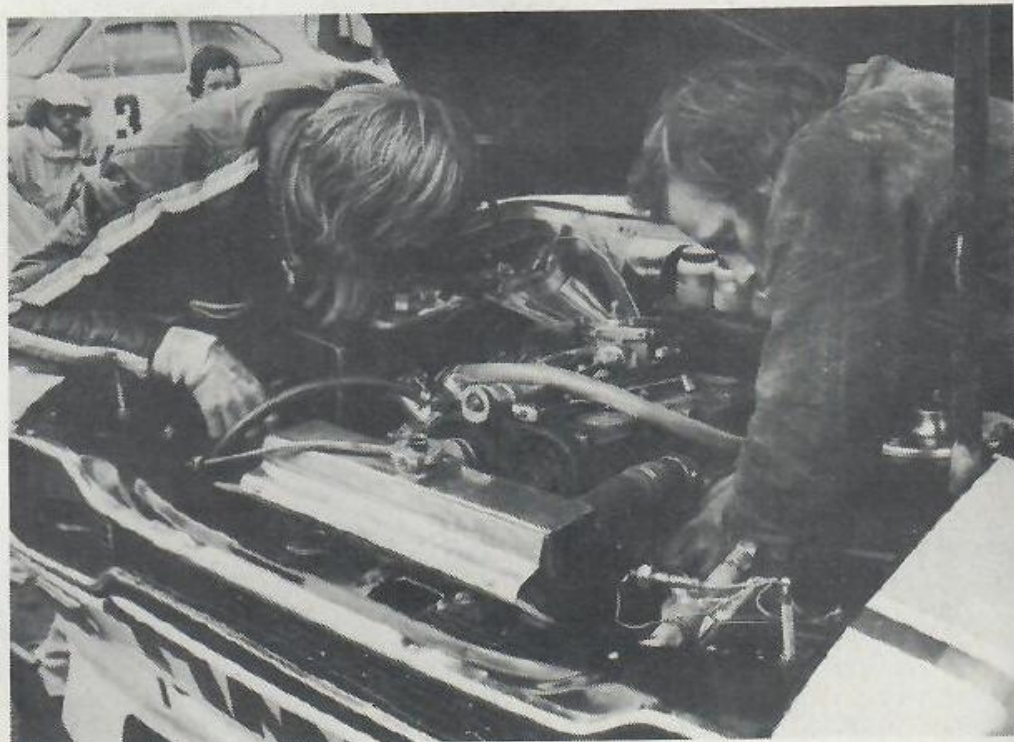
▲ Trubbel och jakt för Raymond och Palle, "Emmas" två stjärnemekar. Mellan de båda heaten lyckades dessa förträffliga herrar skifta inte bara en styrarm och lite annat på vänster framhjul utan dessutom hela växellådan, ett komplicerat jobb på Escorten.
