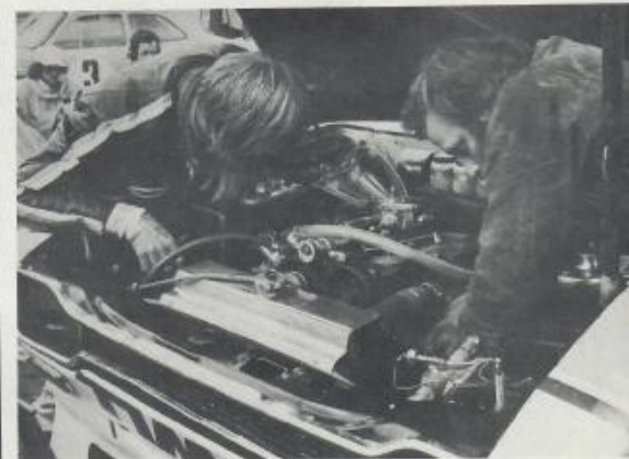
▲ Trubbel och jakt för Raymond och Palle, "Emmas" två stjärnemekar. Mellan de båda heaten lyckades dessa förträffliga herrar skifta inte bara en styrarm och lite annat på vänster framhjul utan dessutom hela växellådan, ett komplicerat jobb på Escorten.
